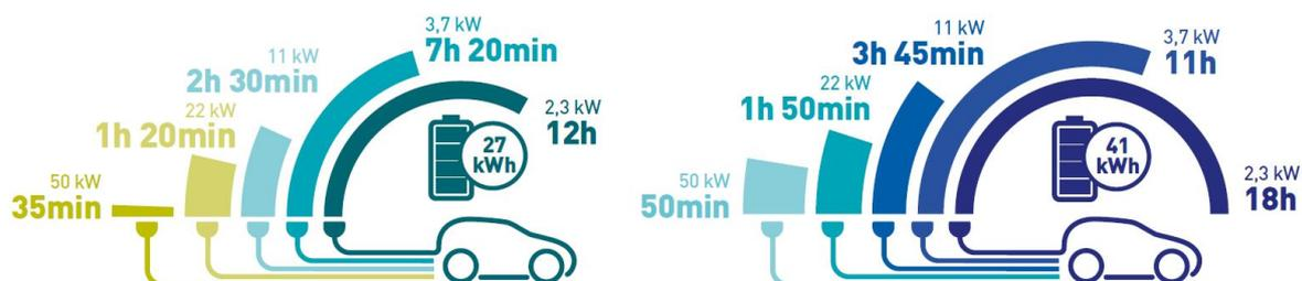
Abbildung 11: Ladedauer unterschiedlicher Batteriekapazitäten (27 kWh/41 kWh) und Ladestationen (2,3 kW - 50 kW). Klima- und Energiefonds; VCÖ 2017: 15)
