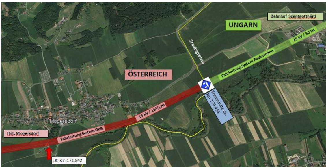
Abbildung 14 Situierung der Trennstelle bei den Varianten 2.3 „C“ und 2.3 (Quelle: google earth, 07.12.2020, Bearbeitung: Panmobile)
